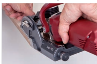
1. La rainure profilée est fraisée avec la Lamello Zeta
