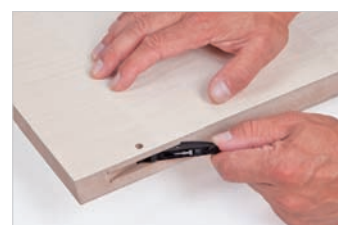
3. L'élément d'assemblage est installé dans la rainure en un clin d'oeil, à la main et sans outils
