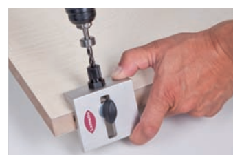
2. Le gabarit est inséré dans la rainure et le perçage est effectué
